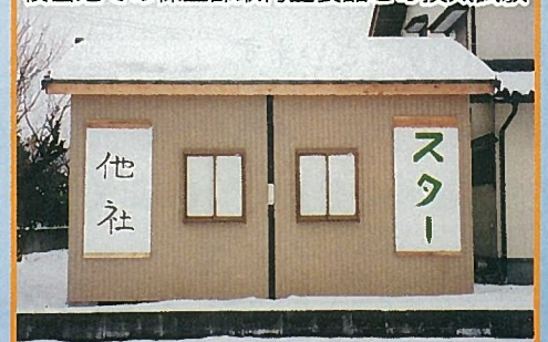
積雪地での棟上部取付型製品との換気試験
